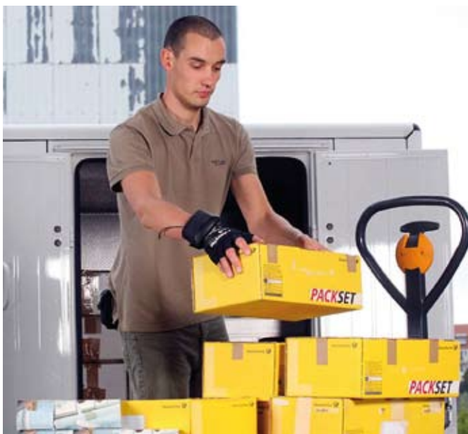
Abb. 3: Einsatz eines RFID-Handschuhs (Quelle: Fraunhofer IFF)
