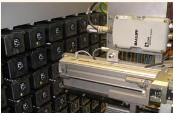
Vollautomatisches Lager für Elektronikbaugruppen in Montagelinie
