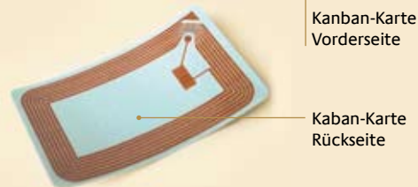
RFID-Kanban-Karte mit integriertem RFID-Transponder
